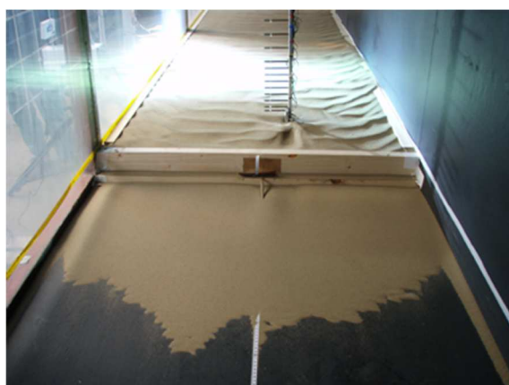
写真－17 実験終了後 飛散状況
