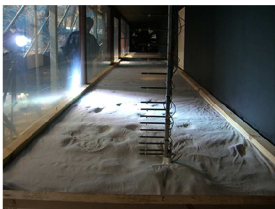
写真－20 実験終了後 飛散状況
